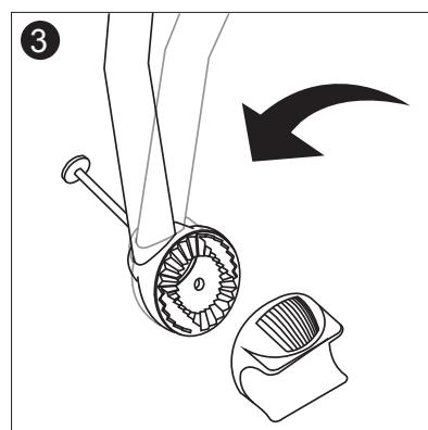
Der obere Rahmen des Fahrradträgers kann nach vorne gekippt werden; Dadurch bleibt die Deichsel des Wohnwagens zugänglich, wenn der Fahrradträger montiert ist.
