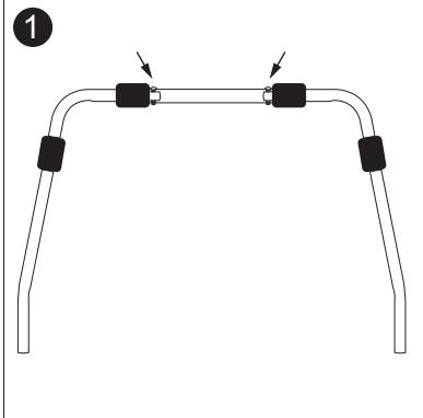
Bevor der obere Rahmen auf den Tragrahmen gesetzt wird, muss er zuerst montiert werden.
