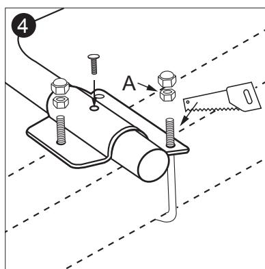
La hauteur du cadre du timon détermine la coupe du fil. Serrer l'écrou (A) avant de couper!
