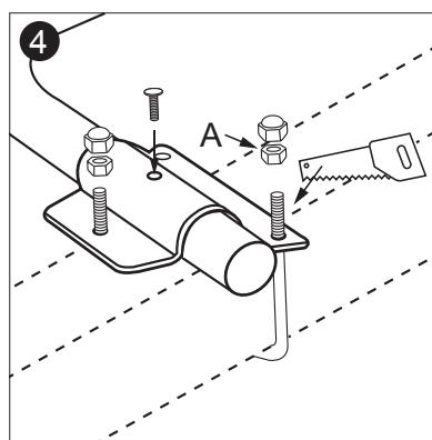
Die Höhe des Rahmens der Deichsel bestimmt das Schneiden des Gewindes. Ziehen Sie zuerst die Mutter (A) an, bevor Sie schneiden!
