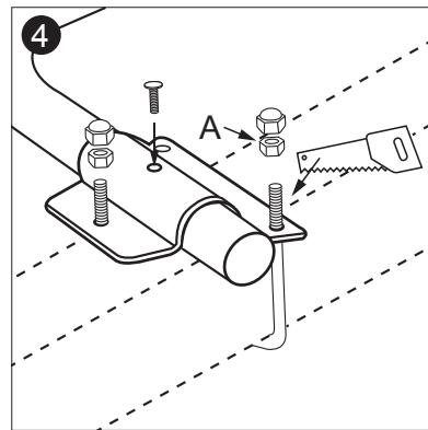
De hoogte van het frame van de diessel is bepalend voor het afzagen van het schroefdraad. Draai voor het afzagen eerst de moer (A) vast!
